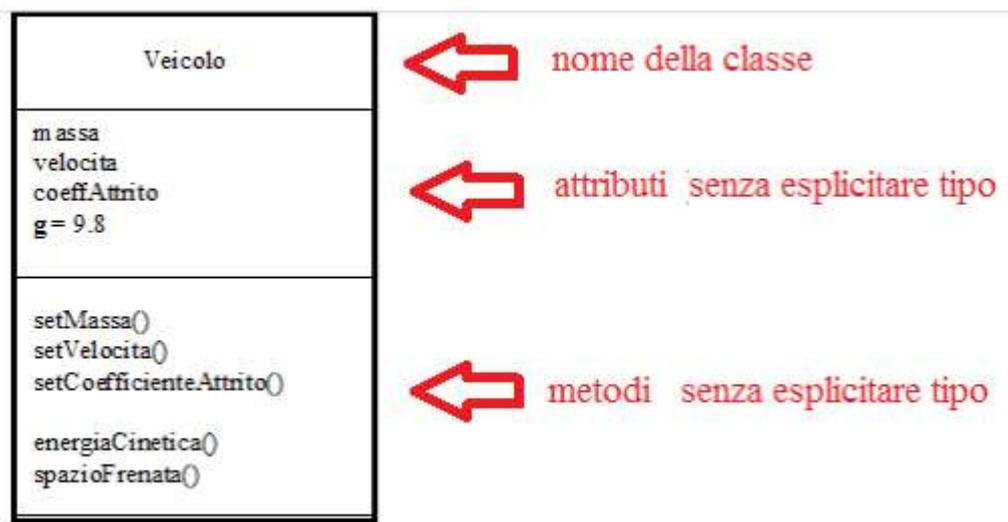
Nella figura seguente, il *diagramma statico della classe senza esplicitare il tipo ma evidenziando i **modificatori di accesso (visibilità)***
